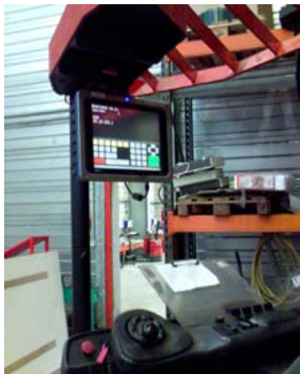
CV60, avec clavier virtuel, embarqué sur chariot élévateur
