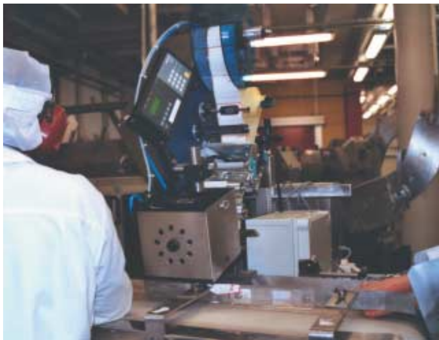
Les étiquettes sont appliquées avec précision, à l'aide d'un applicateur par soufflage, sur les emballages à vide qui défilent rapidement sur le tapis roulant.
